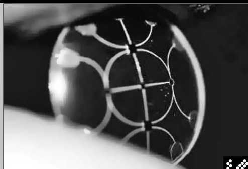
شکل ۳ نمونه اولیه لنز تعداد زیادی اتصال دهنده، قطعات سیلیکونی تک کریستال و قطعات نیمه رسانای ترکیبی را در خود جای داده است (شکل سمت چپ). لنز نمونه دیگر دارای یک تراشه رادیویی و آنتن و یک LED قرمز است (شکل سمت راست).
