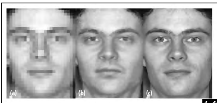
شکل ۷ نتایج استفاده از «افزایش کیفیت» یا Super-Resolution در بهبود تصویر چهره. A: تصویر اصلی کم کیفیت ۳۲×۲۴ پیکسلی B: تصویر اصلی ۱۲۸×۹۶ پیکسلی و C: تصویر ۱۲۸×۹۶ پیکسلی پس از اعمال تکنیک افزایش کیفیت.
