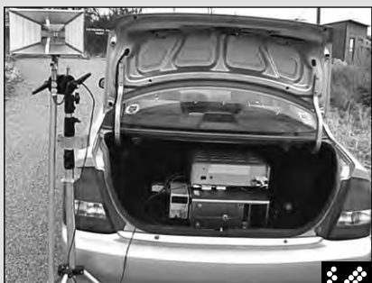
شکل ۷ آزمایشگاه ملی Argonne سیستم مختل کننده‌ای را برپا کرده است که می‌تواند اطلاعات نادرست را از صندوق عقب یک اتومبیل به خورد گیرنده‌های GPS بدهد. گیرنده‌هایی که در آمبولانس‌ها یا کامیون‌ها مورد استفاده قرار می‌گیرد.
