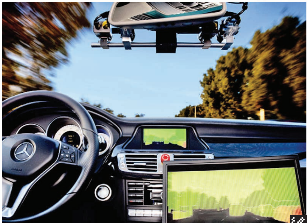
شکل ۱ سیستم 6-D مرسدس که به زودی به صورت استاندارد در مدل‌های رده بالا نصب خواهد شد، از دوربین‌های نصب شده روی شیشه جلو استفاده می‌کند تا خطرات احتمالی را بیابد.
